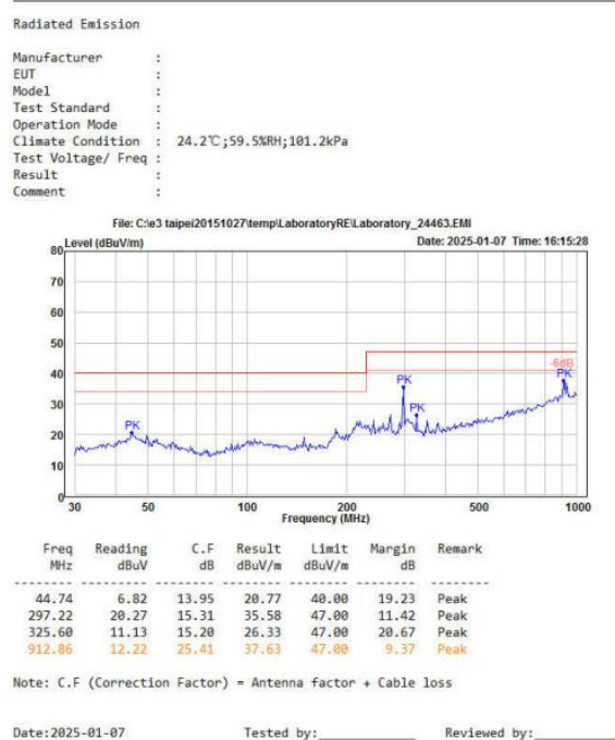
图 5-6 辐射测试水平方向
